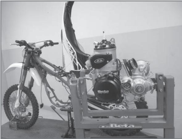
Estrarre il motore dal telaio ed applicarlo allo specifico cavalletto *cod. 3625132 000* con specifica staffa di fissaggio anteriore *cod. 026140030 000*.
