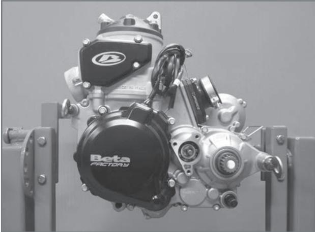
Vincolare il motore allo specifico cavalletto di supporto *cod. 3625132000* mediante il fissaggio anteriore *cod. 026140030 000*, in modo da poter lavorare agevolmente ed in sicurezza. Quindi procedere come di seguito
