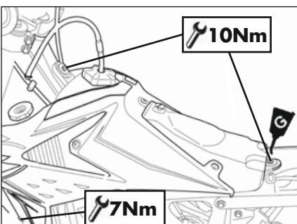
Per il rimontaggio seguire le operazioni in senso opposto a quelle sopra descritte. Serrare le viti serbatoio alle coppie indicate.
