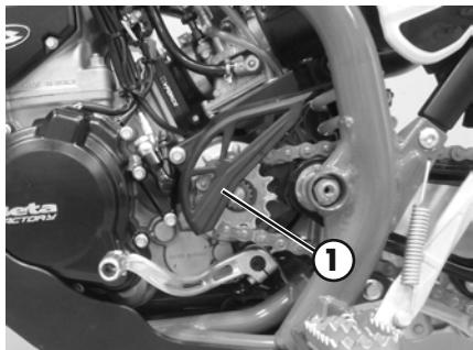
Den Kettenschutz entfernen **1**, Den Tankhahn schließen und ein Tuch unter den Vergaser legen, damit der austretenden Kraftstoff aufgefangen werden kann.
