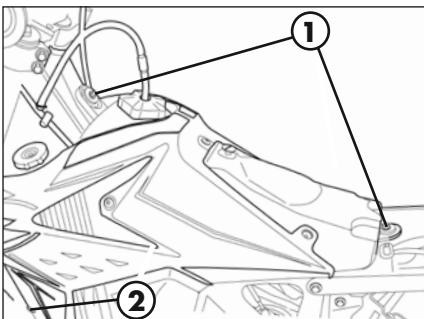
Die beiden Feststellschrauben **1** des Tanks am Rahmen und die Feststellschraube **2** (eine an jeder Seite) der Seitenverkleidung am Kühler entfernen.
