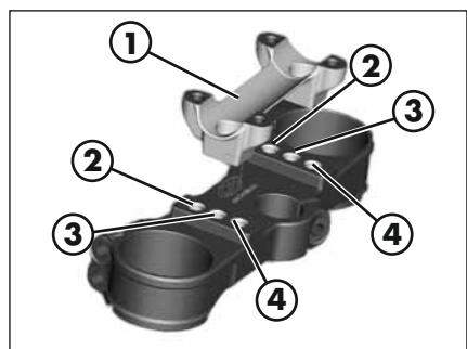
Um die Position der Lenkerschelle einzustellen, die Schrauben in der Abbildung lösen.
