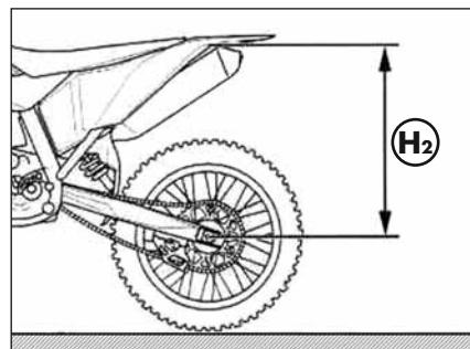
Controleer of de waarde van de statische compressie  $X = H_1 - H_2$  het gerapporteerde op pag. 12. Als dat niet het geval is, voer dan de afstelling van veervoorspanning uit zoals hierboven beschreven.
