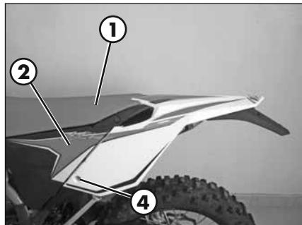
Haal de zeshoekige sleutel **3** en de bijbehorende steeksleutel (8 mm) eruit, waardoor het mogelijk is de schroef **4** los te draaien.
