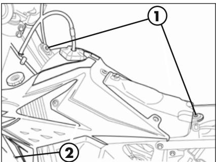
Verwijder de twee bevestigingsschroeven **1** van de tank op het frame en de bevestigingsschroef **2** (één per kant) van de afdekking op de radiator.
