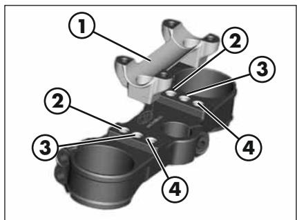
Per regolare la posizione del cavallotto rimuovere le viti indicate in figura.
