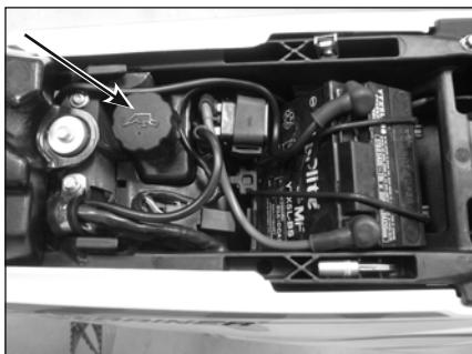
Para abrir el tapón del depósito girarlo en sentido contrario a las agujas del reloj.
