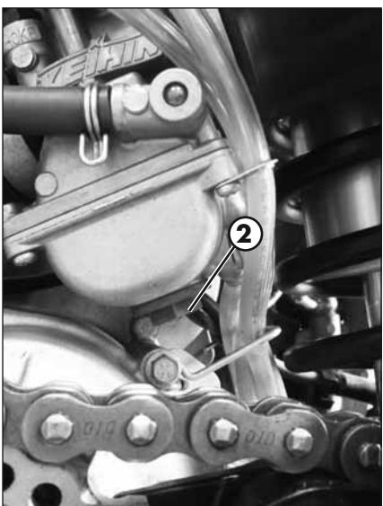
Aprire la vite di scarico **2** per scaricare il carburante. Richiudere la vite di scarico. Riapplicare la protezione catena e serrare le viti a 10Nm.
