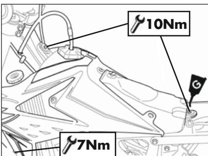
Beim Wiedereinbau in umgekehrter Reihenfolge wie beim Ausbau vorgehen. Die Schrauben mit den angegebenen Drehmomenten anziehen.
