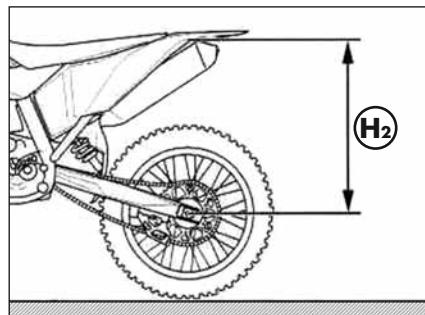
Verificare che il valore della compressione statica  $X = H_1 - H_2$  rispecchi quanto riportato a pag. 12. In caso contrario eseguire la regolazione del precarico molla come descritto sopra.
