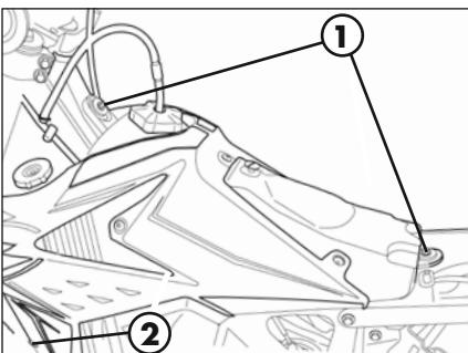
Rimuovere le due viti **1** di fissaggio serbatoio al telaio e la vite **2** (una per lato) di fissaggio del fianchetto al radiatore.
