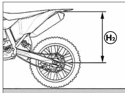
Der Wert der statischen Durchhang  $X = H_1 - H_2$  müssen gleich sein wie auf Seite 12 gezeigt. Andernfalls gezeigt, den Federvorspannung einstellen wie oben beschrieben.
