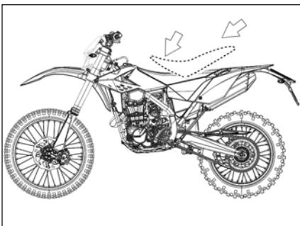
Enfoncer la selle vers le bas dans la partie centrale, et la pousser simultanément vers l'avant jusqu'à ce que la cosse femelle ne s'accroche dans son logement.
