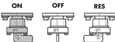
OFF: brandstoftoevoer gesloten. De brandstof kan niet van de tank naar de carburateur gaan.
