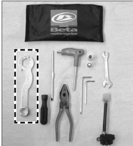
Nota: per la movimentazione delle ghiere utilizzare la specifica chiave fornita nel corredo attrezzi indicata in figura.
