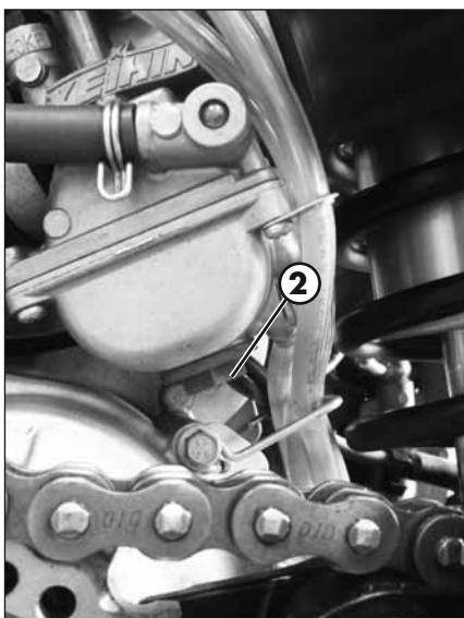
Die Auslassschraube öffnen **2**, um den Kraftstoff abzulassen. Die Auslassschraube wieder schließen.
