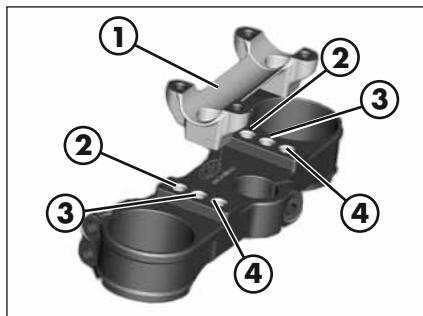
Haal de schroef weg zoals aangegeven in de figuur om de positie van de brug aan te passen.
