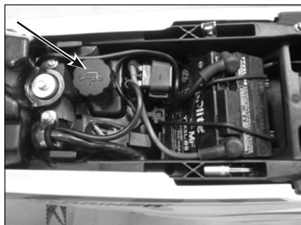
Pour ouvrir le bouchon du réservoir le tourner en sens antihoraire
