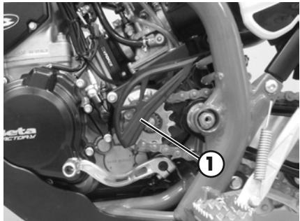
Enlever la protection de la chaîne **1**, fermer le robinet du réservoir et placer un chiffon sous le carburateur de façon à pouvoir récupérer le carburant qui coule.
