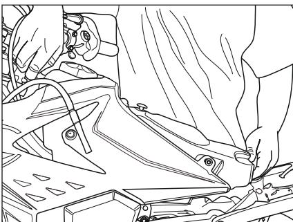
Den Tank komplett mit Seitenverkleidung entfernen.
