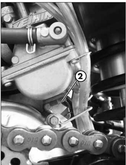
Open de afvoerschroef **2** om de brandstof te lozen. Sluit de afvoerschroef weer. Plaats de kettingbescherming weer en draai de schroef dicht op 10 nm.
