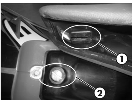
Per il rimontaggio inserire la cavità **1** della sella nella guida **2**.
