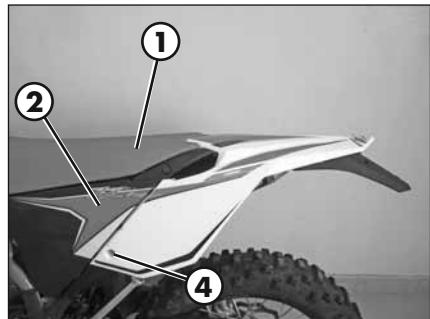
Sfilare la chiave esagonale **3** e relativa chiave a bussola (8 mm) tramite cui è possibile svitare la vite **4**.
