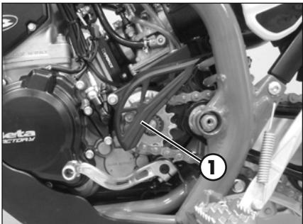
Rimuovere la protezione catena **1**, chiudere il rubinetto serbatoio e posizionare un panno sotto il carburatore in modo da poter raccogliere il carburante che fuoriesce.
