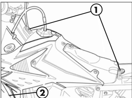
Quitar los dos tornillos **1** de fijación del depósito al bastidor y el tornillo **2** (uno por lado) de fijación del costado al radiador.
