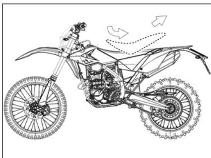
Den Sattel in Richtung des Hinterrads des Motorrads abziehen.
