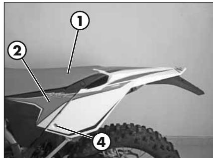
Mit dem Steckschlüssel **3** (8 mm) kann die Schraube **4** entfernt werden.
