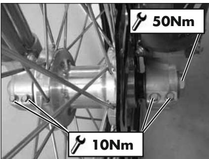
Die Radachse und die Schrauben des Beins anziehen.
