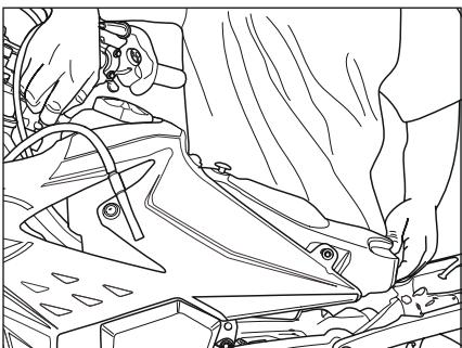
Til de tank compleet op van de zijafdekking.
