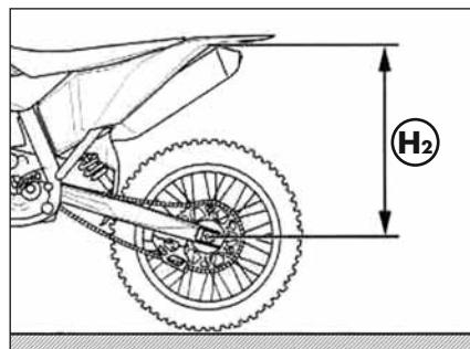
Comprobar que el valor del recorrido estático  $X = H_1 - H_2$  coincide con el que se muestra en la página 11. De lo contrario, ajustar la precarga del muelle como se describe anteriormente.
