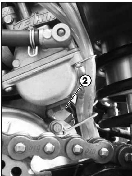
Quite la protección cadena **1**, cierre la llave depósito y ubique un paño debajo del carburador de manera de poder recoger el combustible que se derrama.
