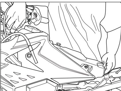
Retirer le réservoir avec les carénages.
