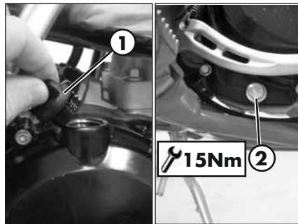
Fermer le bouchon de remplissage **1**.
