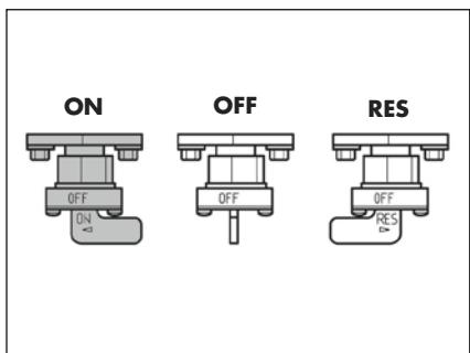
**OFF**: erogazione carburante chiusa. Il carburante non può passare dal serbatoio al carburatore.
