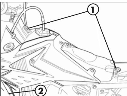
Retirer les deux vis **1** de fixation du réservoir au châssis et la vis **2** de fixation (une par côté) du carénage au radiateur.
