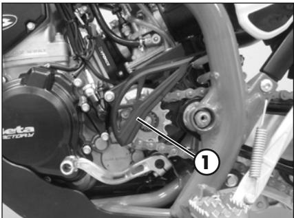
Verwijder de kettingbescherming **1**, sluit de brandstofkraan en plaats een doek onder de carburateur om de brandstof die eruit lekt te kunnen opvangen.
