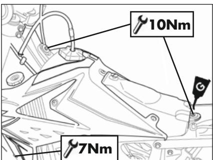
Voer voor het weer in elkaar zetten de hierboven beschreven handeling in omgekeerde volgorde uit. Draai de tankschroeven vast bij de aanhaalmomenten.
