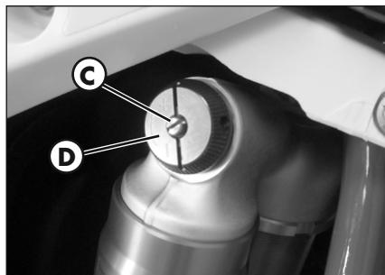
Regolazione per alte velocità in compressione:
