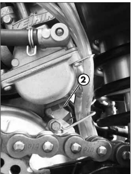
Ouvrir la vis d'échappement **2** pour vidanger le carburant. Refermer la vis d'échappement.
