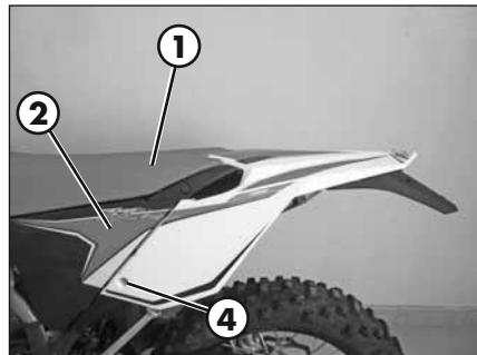
Quite la llave de tubo hexagonal de **3** y la correspondiente clave (8mm) a través del cual desenrosque el tornillo **4**.
