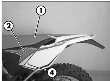
Enlever la clé hexagonale **3** et la relative clé à douille (8mm) par laquelle il est possible de dévisser la vis **4**.
