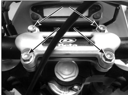
Para regular la posición de la brida inferior, quitar los tornillos indicados en la figura.
