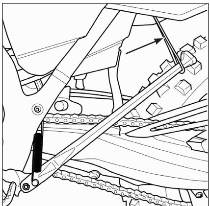
Sur le tout terrain, la béquille fermée peut être fixée ultérieurement avec une bande en caoutchouc.
