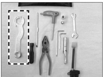
Opmerking: gebruik voor het draaien van de bout de speciale moersleutel, meegeleverd in de gereedschapskit aangegeven in de afbeelding.
