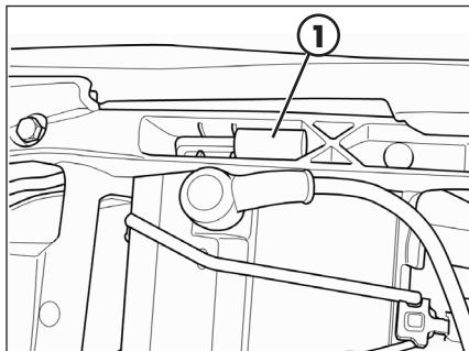
Im Batteriefach befinden sich der Sechskantschlüssel **1** und der entsprechende Innensechskantschlüssel (8 mm). Um auf sie zugreifen zu können, muss der Sitz entfernt werden (Seite 80).
