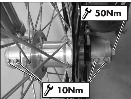
Draai de wielas en de schroeven voor de steunvoet vast bij het aangegeven aanhaalmoment.
