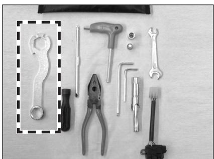
Nota: para el desplazamiento de las abrazaderas utilizar la llave específica indicada en la figura y que se entrega junto con las herramientas.
