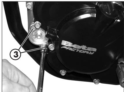
Den neuen Ölfilter einsetzen, den Deckel mit dem O-Ring montieren, die beiden Schrauben anbringen und mit 10 Nm festziehen.
