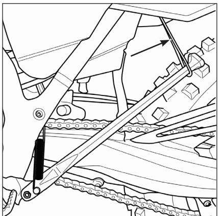
Se si procede con il motociclo in fuoristrada, il cavalletto chiuso può essere ulteriormente fissato con l'elastico in gomma.
