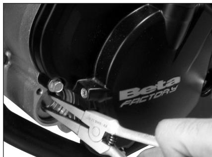
Plaats de nieuwe papieren filter en sluit de afdekking opnieuw door de twee schroeven aan te halen met een koppel van 10 Nm.
