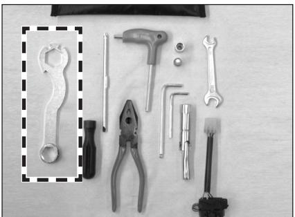
Nota: per la movimentazione delle ghiere utilizzare la specifica chiave fornita nel corredo attrezzi indicata in figura.
