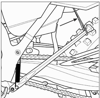
Bei Fahrten im Gelände kann der geschlossene Seitenständer zusätzlich mit einem Gummiband gesichert werden.
