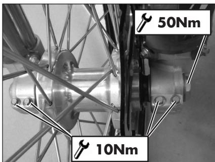
Die Radachse und die Schrauben des Beins anziehen.
