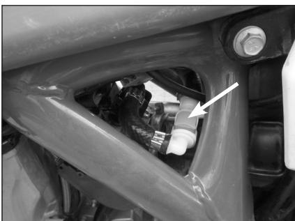
Auf den Schalter des Schnappverschlusses drücken, um den Benzinschlauch abzutrennen.
