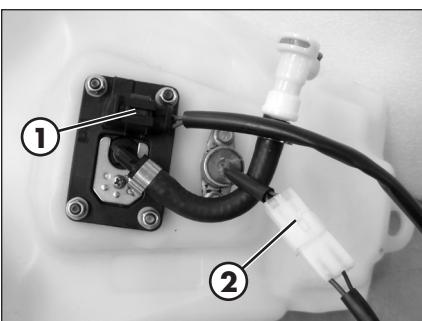
Ontkoppel de elektrische connector **1** en **2**.
