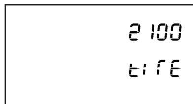
De wielomtrek wordt opgeslagen door de knoppen "MODE" en "SET" langer dan 2 seconden ingedrukt te houden. De indicatie "Saved" verschijnt gedurende 1 seconde op het scherm.
