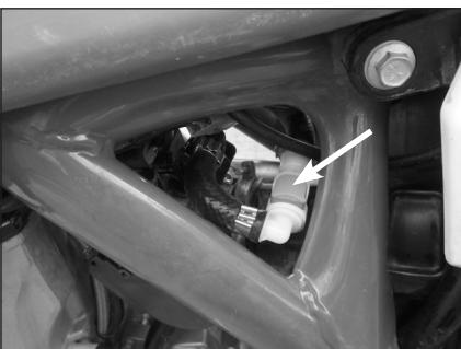
Débrancher la durite à essence en appuyant sur le bouton de raccordement rapide prévu à cet effet.
