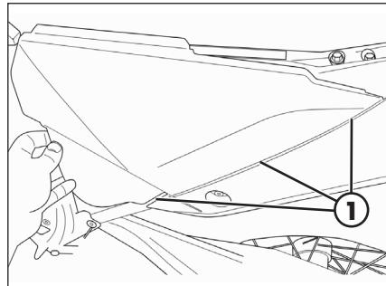
Die Seitenwand in Richtung der Fahrzeug schieben.
