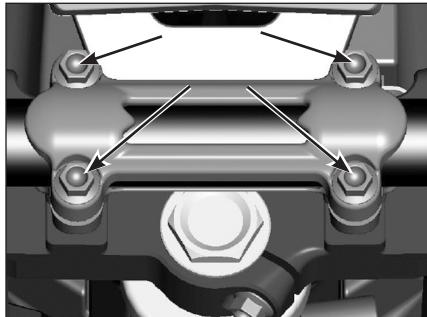
Pour régler la position du cavalier, retirer les vis indiquées en figure.
