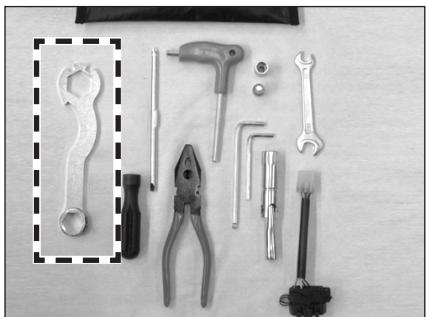
ANMERKUNGEN: für das Handling der Nutmuttern den speziellen, mit dem Werkzeugzubehör mitgelieferten Schlüssel, der in der Abbildung zu sehen ist, verwenden.
