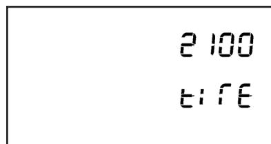
Wenn die Tasten „MODE“ und „SET“ für mehr als 2 Sekunden gedrückt gehalten werden, wird der Reifenumfang gespeichert. Der Hinweis „Saved“ (gespeichert) wird für 1 Sekunde auf dem Bildschirm angezeigt.
