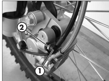
NOTE: au cours de cette opération, il est important d'alimenter constamment le réservoir du maître cylindre pour compenser l'huile qui s'écoule.
