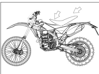
Den Sattel in der Mitte nach unten drücken und gleichzeitig nach vorn schieben, bis der Schnappverschluss einrastet.
