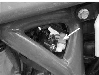
Ontkoppel de benzinebus door op de voorziene knop van de snelkoppeling te drukken.
