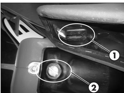
Die Schale **1** des Sattels in die Führung **2** einsetzen.
