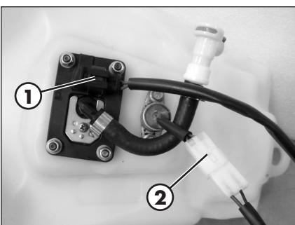
Débrancher le connecteur électrique **1** et **2**.
